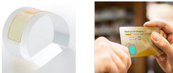
Рис.2. Дактилоскопічний датчик на скляній підкладці з ємнісним сенсором
