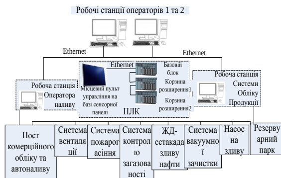
Рис.1. Структура АСУ ТП нафтопереробного виробництва
