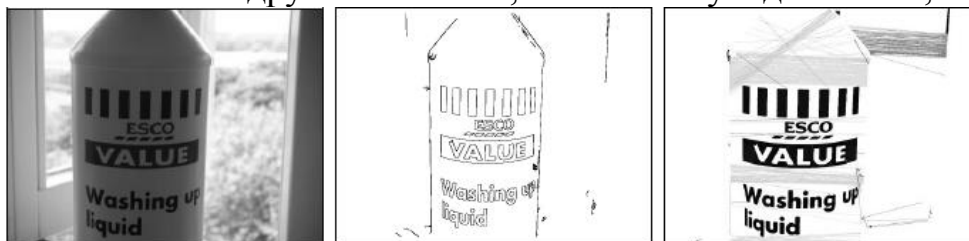
Рис 1. Построение SWT-изображения: а - исходное изображение, б - инвертированное контурное изображение, в - SWT-изображение.
