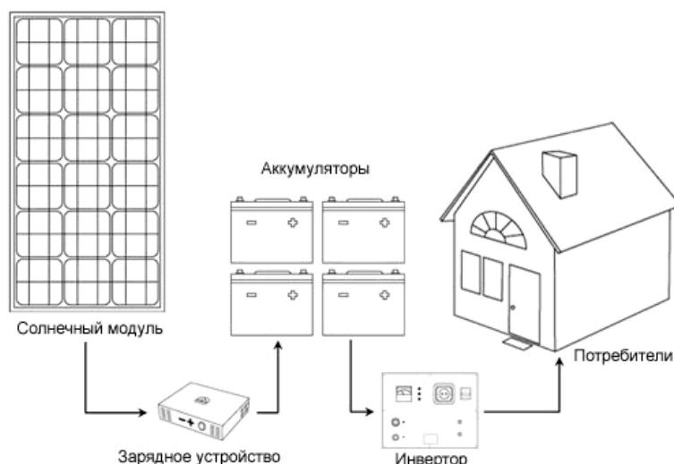
Рис. 1 - Структурная схема построения солнечной электростанции для дома
