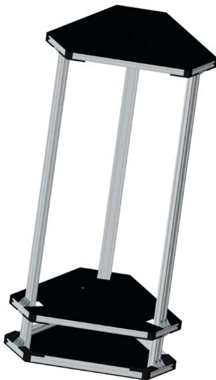
Рисунок 2.2 – Розроблена конструкція корпусу 3D принтера з кінематикою Delta
