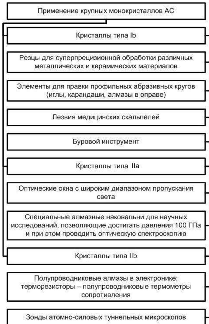
Рис. 1 - Применение крупных монокристаллов алмазов синтетических
