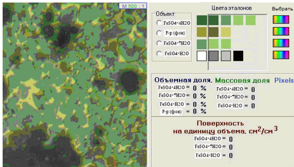
Рисунок 2.9 – Інтерфейс системи комп'ютерного аналізу травильного розчину
