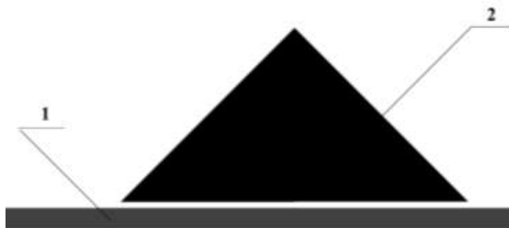
Рисунок 1 – Схема передачі енергії від хвилеводу до призми: 1 – хвилевід; 2 – призма
