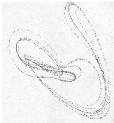
Рис. 2.4. Перетин Пуанкаре дивного аттрактора.
