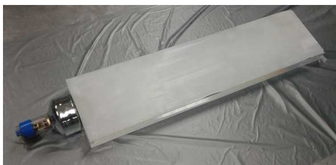
Рисунок 3.9 – Вигляд сцинтиляційного сендвіча CsI:Tl – ПС
