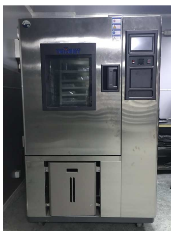
Рисунок 2.8 – Камери тепла та холоду Programmable Temperature/Humidity Chamber (K type)
