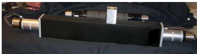
Рисунок 3.20 – Спектрометричний комбінований детектор NaI:Tl – ПС фотонів гамма-випромінювання (для пішохідних РПМ)
