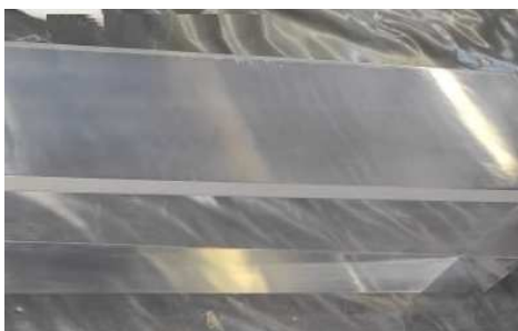
Рисунок 2.3 – Сендвіч з моношару NaI:Tl та ПС
