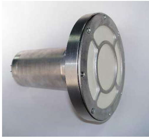
Рисунок 4.9 – Комбінований детектор альфа- та бета-частинок на основі гетерогенного шару ZnSe:Al ( \varnothing 130 \times 0,9 мм)
