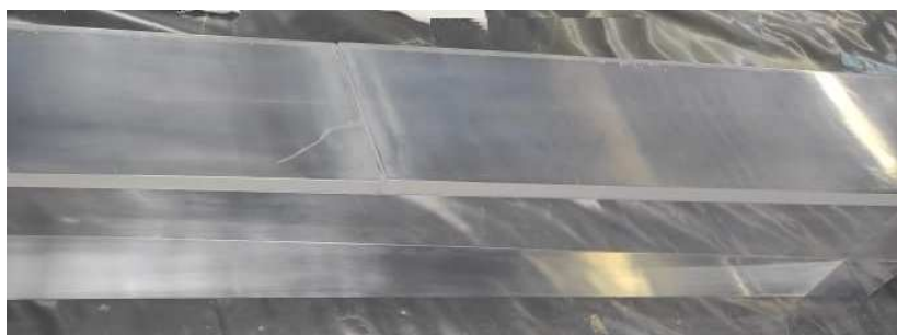
Рисунок 3.8 – Вигляд сцинтиляційного сендвіча NaI:Tl – ПС
