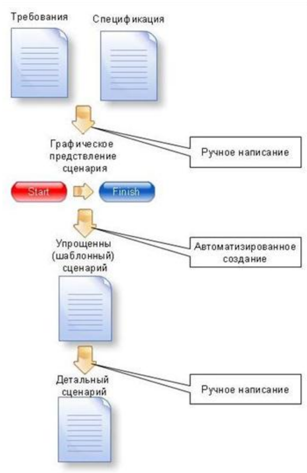
Рисунок Б3- Схема створення тестового сценарію з використанням технології «ATSD»
