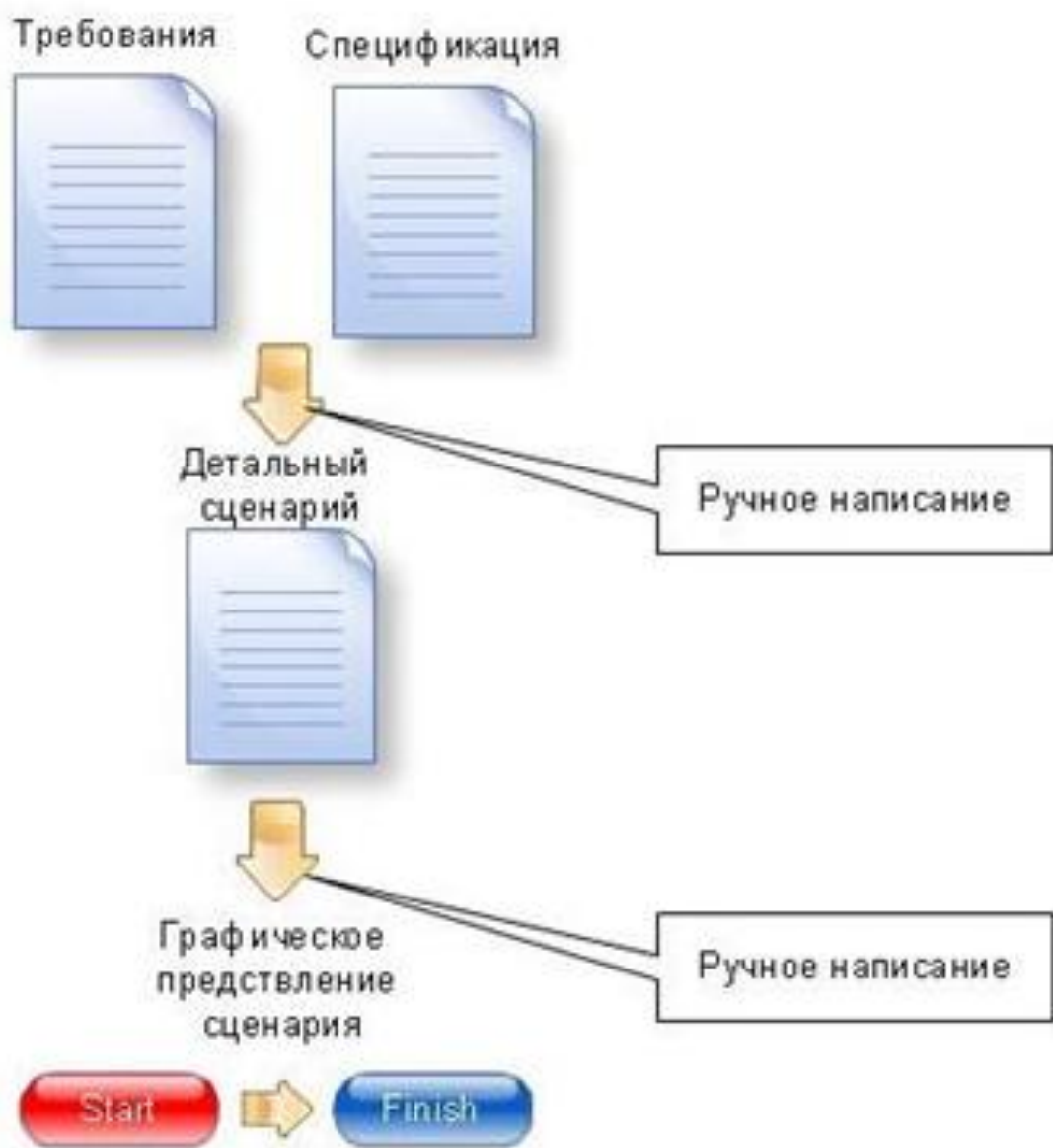
Рисунок Б2- Схема створення тестового сценарію з використанням технології «Handmade Graph»
