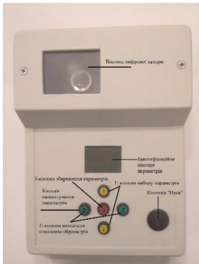
Рис.2. Зовнішній вигляд робочої панелі макету приладу ЦРЕФГР.
