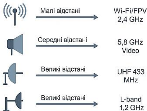
Рис. 1. Робочі частотні діапазони систем управління БПЛА
