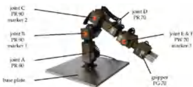
Рис. 1. Схема багатоланкового маніпулятора
