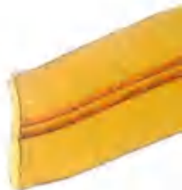
Рис.4. Розрив шлейфа досліджуваного зразка після динамічних вигинів
