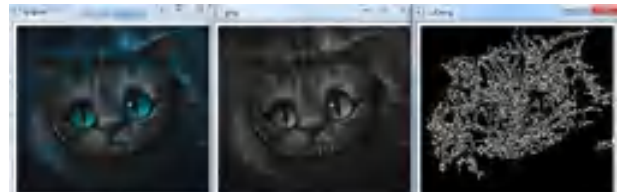
Рис.4. Алгоритм Канні (Canny)
