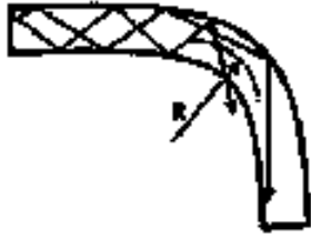
Рис. 2. Втрати сигналу на вигині оптичного волокна
