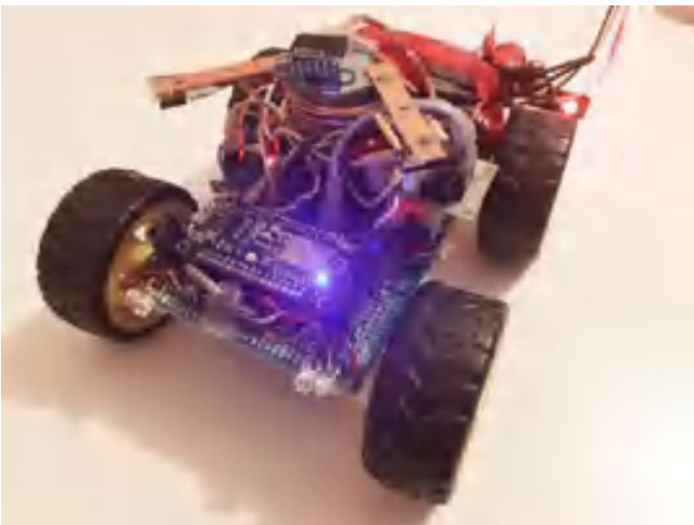
Рис. 1. Робот з платою керування на базі чіпа esp8266
