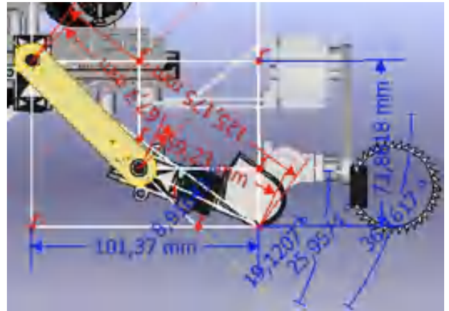
Рис.1. Вид збоку на площину, що спільна для суглобів стегна та гомілки ноги робота, які регулюють нахили платформи
