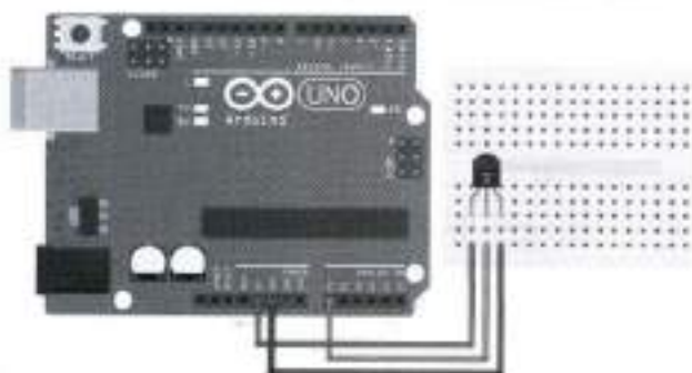
Рис. 2. Типове підключення датчика TMP36 Fig. 2. Connect TMP36 sensors to the Arduino Uno
