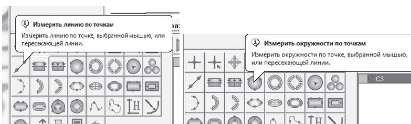
Рис. 4. Застосування панелі інструментів інтерфейсу для виконання вимірювань
