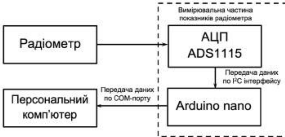
Рисунок 4.5 – Структурна схема модуля комунікації між радіометром та ПК
