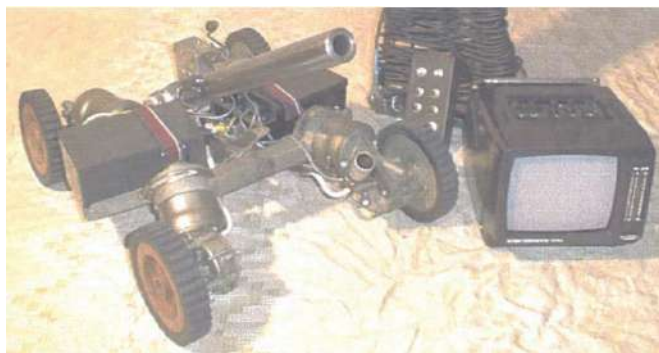
Рис. 1. Дистанційно-керований апарат для розвідки та знешкодження вибухонебезпечних предметів
