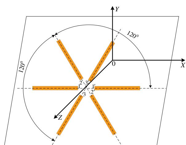
Рисунок 5 – Випромінювальна структура трифазного ректенного елемента
