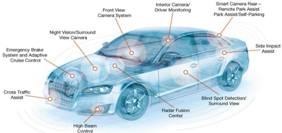
Рисунок 1 – ADAS і автономне водіння потребують кількох датчиків
