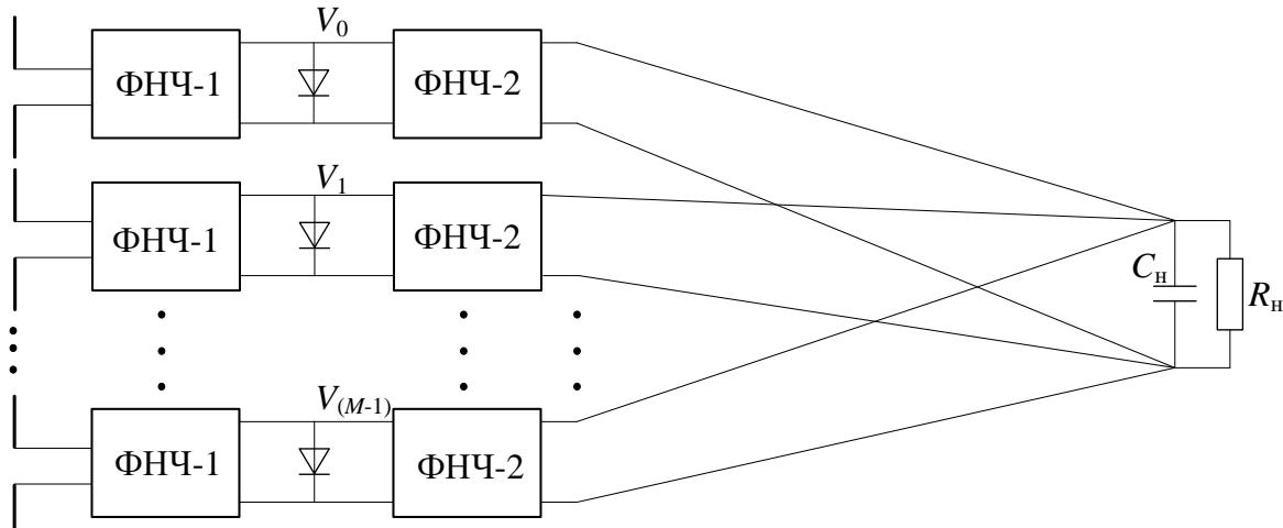
Рисунок 4 – Структурна схема багатофазного ректенного елемента
