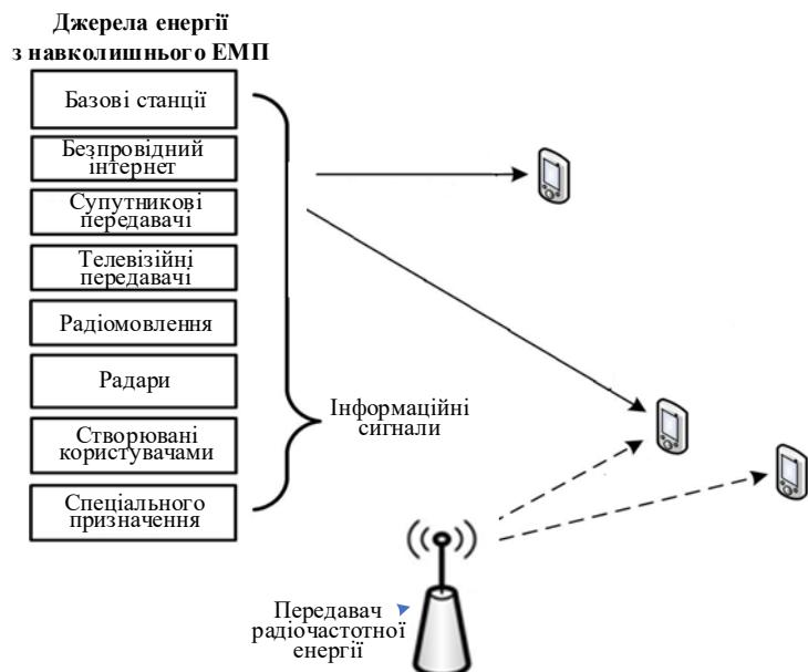
Рисунок 1 – Енергопостачання малопотужних пристрій за рахунок видобування енергії з навколошнього ЕМП
