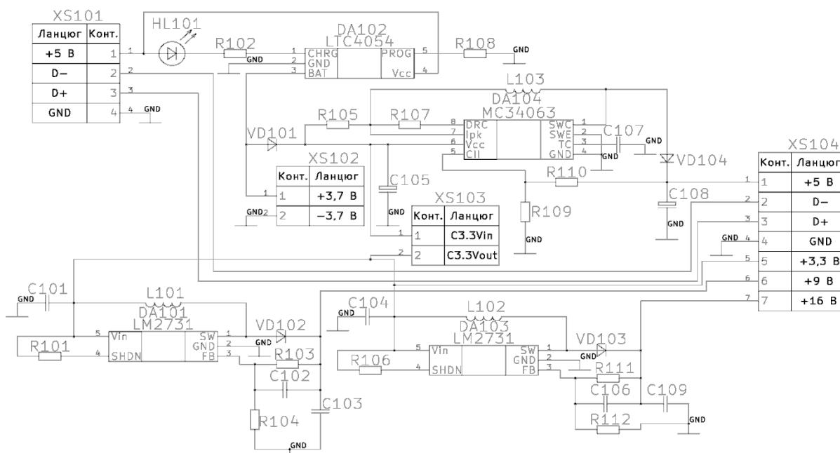
Рисунок 1 – Принципова схема БЖ мобільного робота-графопобудовника
