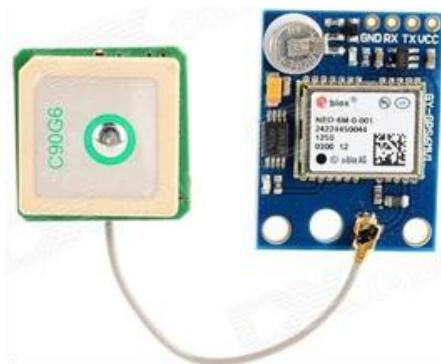
Рисунок 2 – Зовнішній вигляд модуля GPS позиціонування NEO-6M
