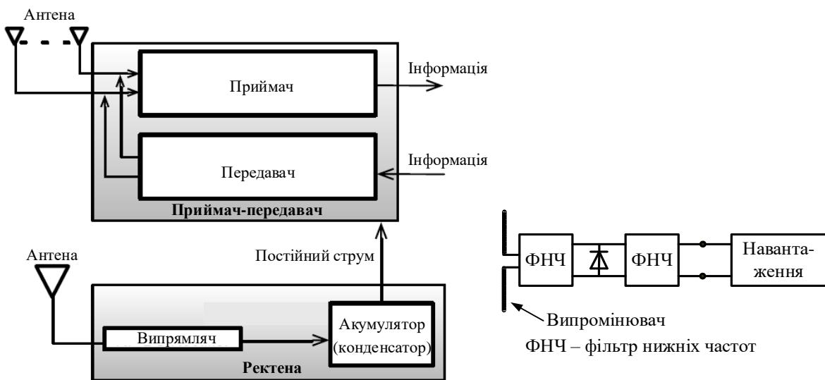
Рисунок 2 – Архітектура вузла IoT з безпровідним живленням
