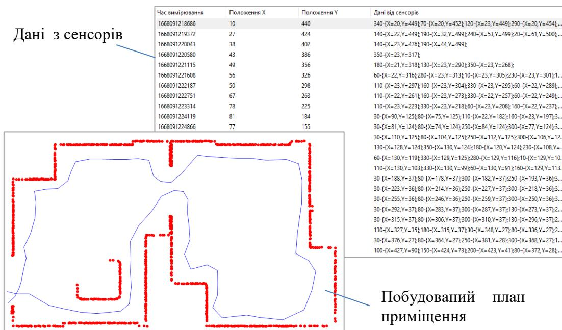
Рисунок 3 – Приклад даних, що отримані з сенсорів робота та побудованого плану приміщення
