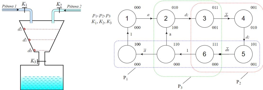
Рисунок 1 – Дозуючий пристрій (а) і граф переходів (б)
