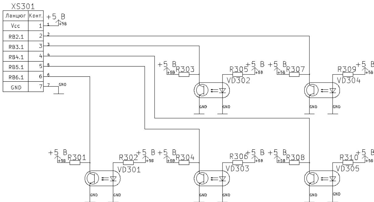
Рисунок 1 – Принципова схема блока датчиків ліній мобільного робота-графопобудовника
