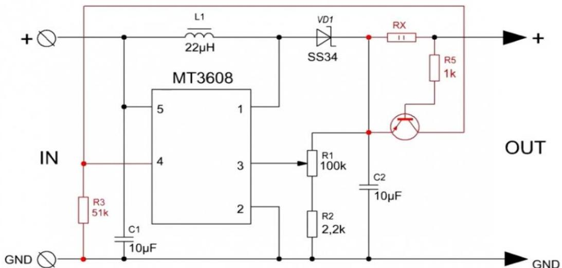
Рисунок 4 – Схема модуля джерела живлення MT3608
