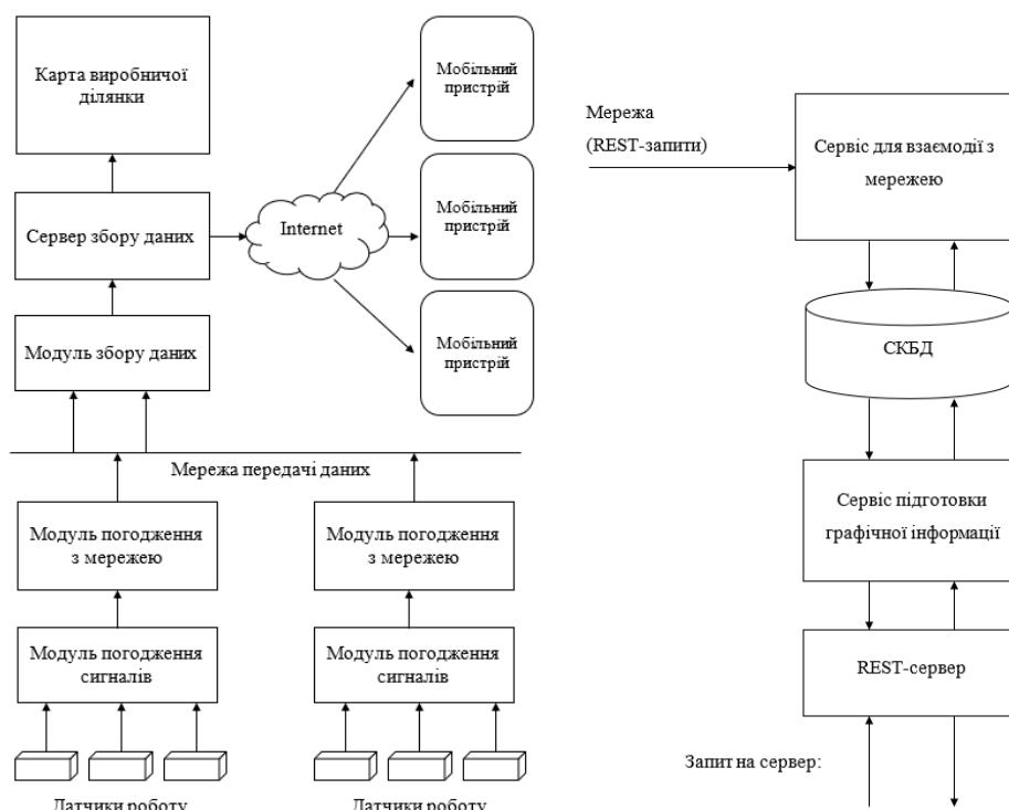
Рисунок 1 – Архітектура взаємодії сервера з сенсорами мобільного робота
