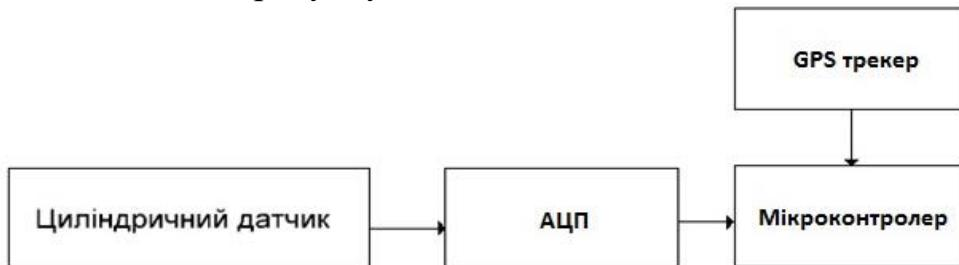
Рисунок 1 – Структурна схема підсистеми ідентифікації вибухонебезпечних предметів
