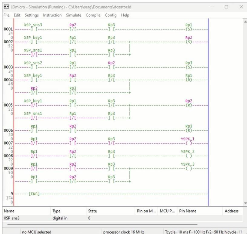
Рисунок 3 – Східчаста діаграма, що реалізує роботу дозуючого пристрою
