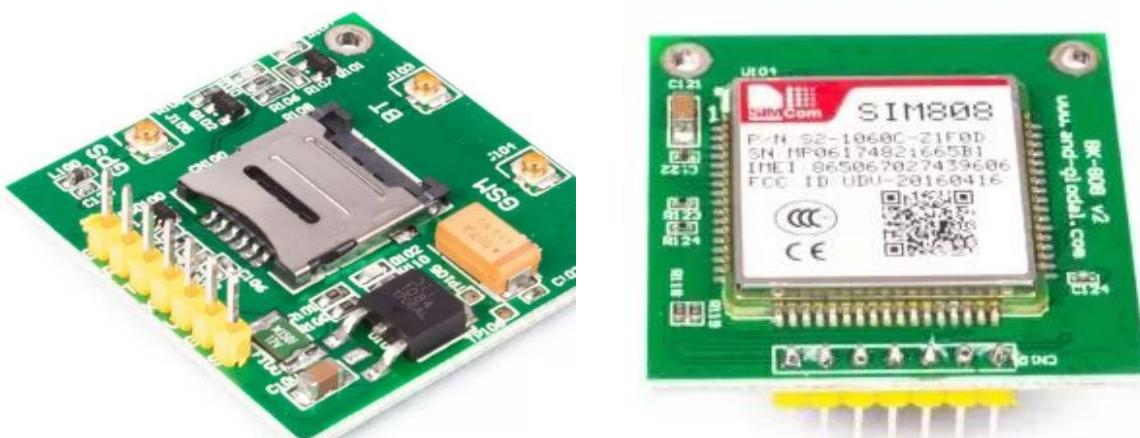
Рисунок 1 – Зовнішній вигляд вбудованого модуля SIM808
