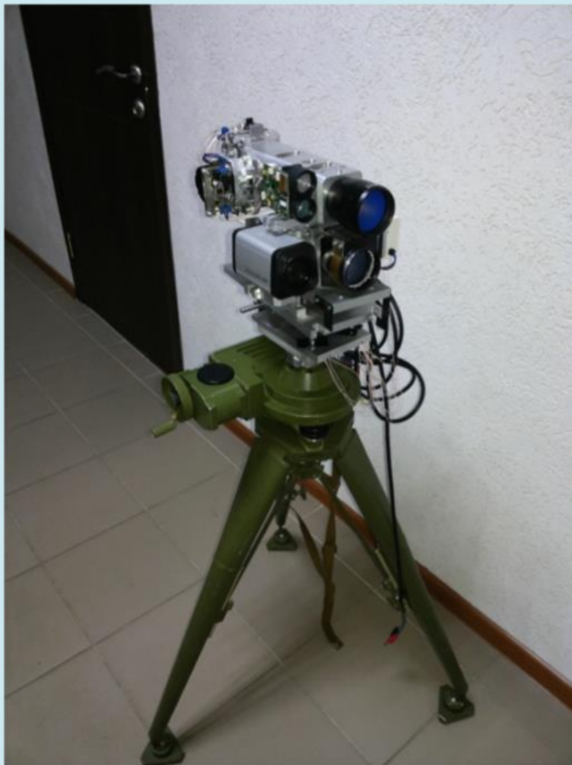
Лазерна система реєстрації оптики (ФОЕТ, ЦККНО, ДЗ)
