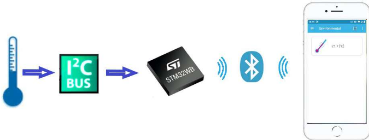
Рисунок 1 – Архітектура розробленої системи контролю температури
