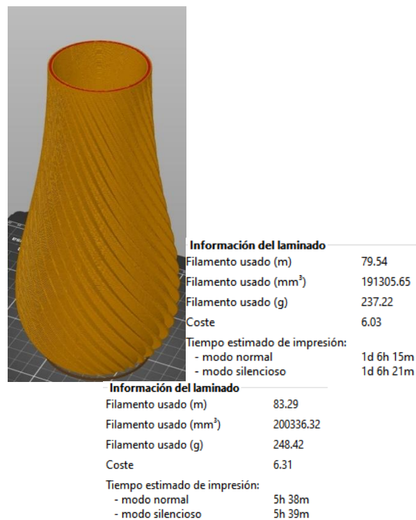
Рис. 4. Параметри друку при використанні екструдера для гранул
