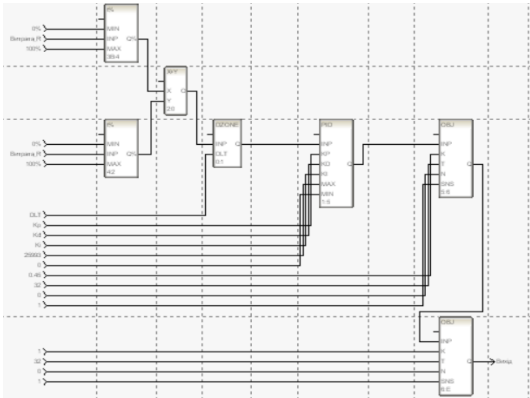
Рис. 3. Програма стабілізації температури у колоні шляхом зміни подачі газу у верхньому та нижньому байпасах
