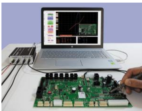
Рис. 3. Пристрій FADOS9F1-24VoF, призначений для пошуку несправності методом аналізу ВАХ щодо збережених сигнатур
