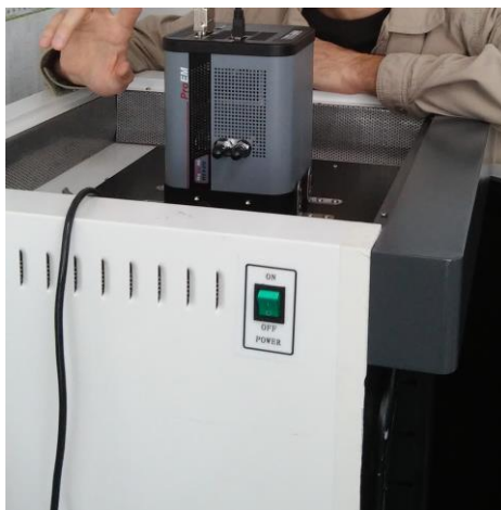
Рисунок 4.15 – EM-CCD Princeton Instruments ProEM HS 512BX3, що встановлено згори світлозахисної камери.
