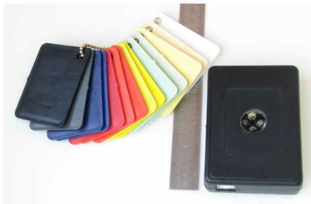
Рисунок 5.2 – Зовнішній вигляд колориметра «С 1001» (з права) з кольоровими зразками (з ліва).
