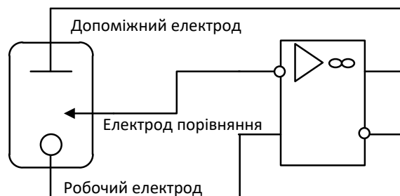
Рисунок 1.2 - Схема замкнутих контурів зовнішніх ланцюгів потенціостата
