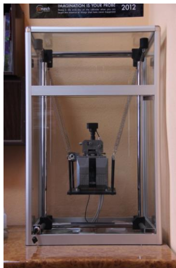
Рисунок 3.2 – Зовнішній вигляд атомно-силового мікроскопу NT-206
