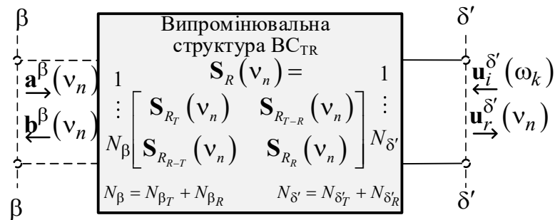
Рисунок 3.1 – Багатополісник еквівалентний випромінювальній структурі системи БПЕ
