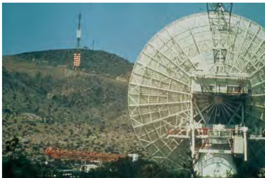
Рисунок Д.2 – Експеримент по БПЕ проведений у США, Голдстоун, 1975 р. (ректена 3,4 \times 7,2 м 2 містила 5 тис. ПВЕ кожний з яких перетворював 6 Вт НВЧ-потужності; обмірюваний ККД ректени 82 % на частоті 2388 МГц; потужність постійного струму в навантаженні ректени 30 кВт)
