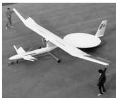
Рисунок Д.9 – Модель SHARP (масштаб 1:8) (а) і її крило з розміщеною на ньому ректеною (б)
