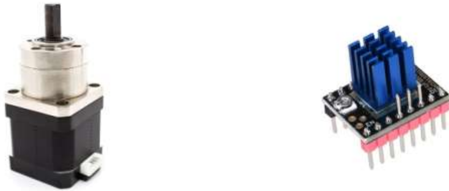
а) б) Рисунок 5.2 – Кроковий двигун NEMA 17 (а) драйвер крокового двигуна TMC2208 (б)
