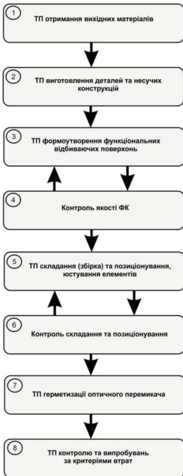
Рисунок 1.5 –Типовий технологічний процес виготовлення мікроелектромеханічних перемикачів
