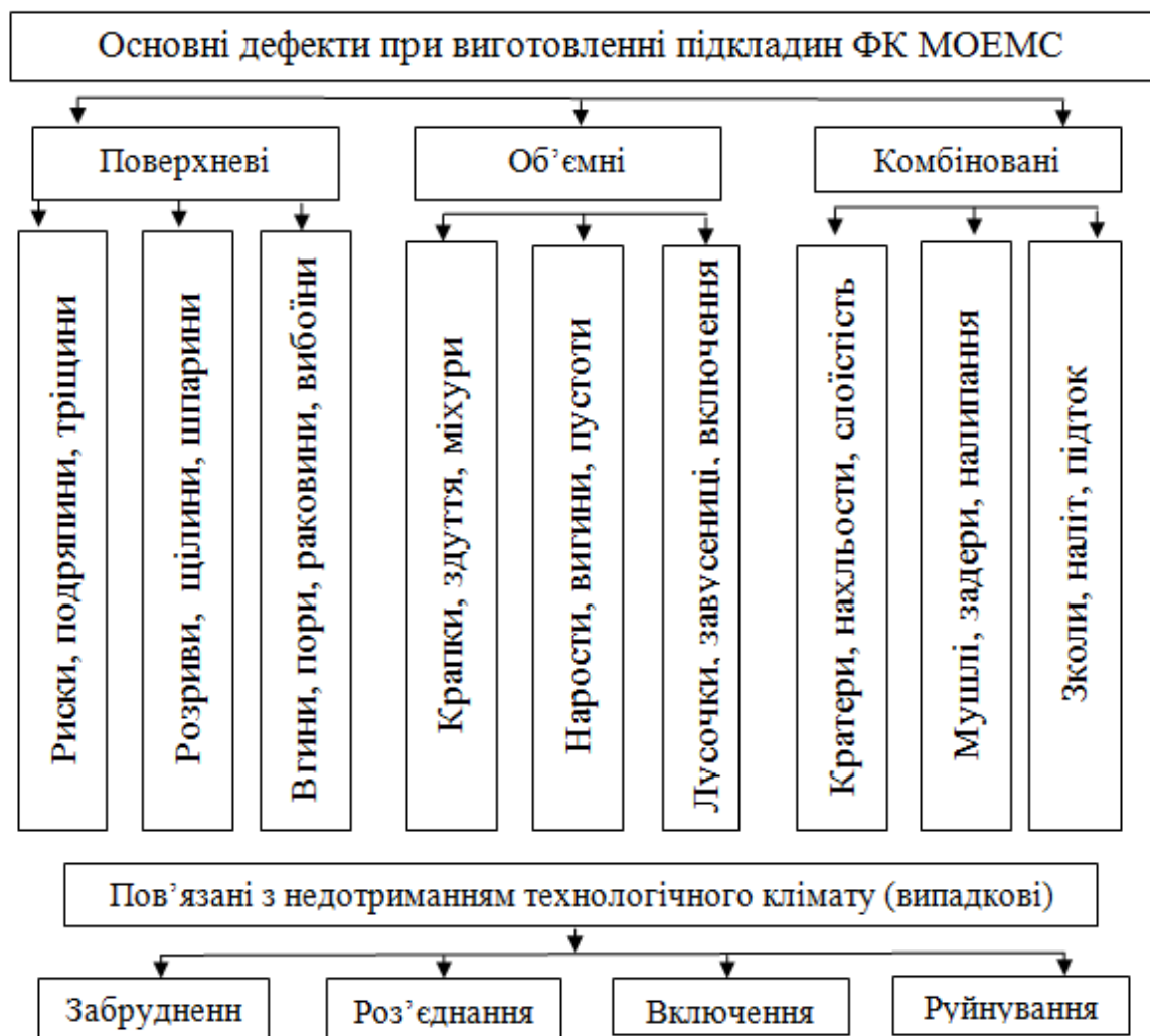
Рисунок 1.7 – Основні дефекти при виготовленні підкладин ФК МОЕМС
