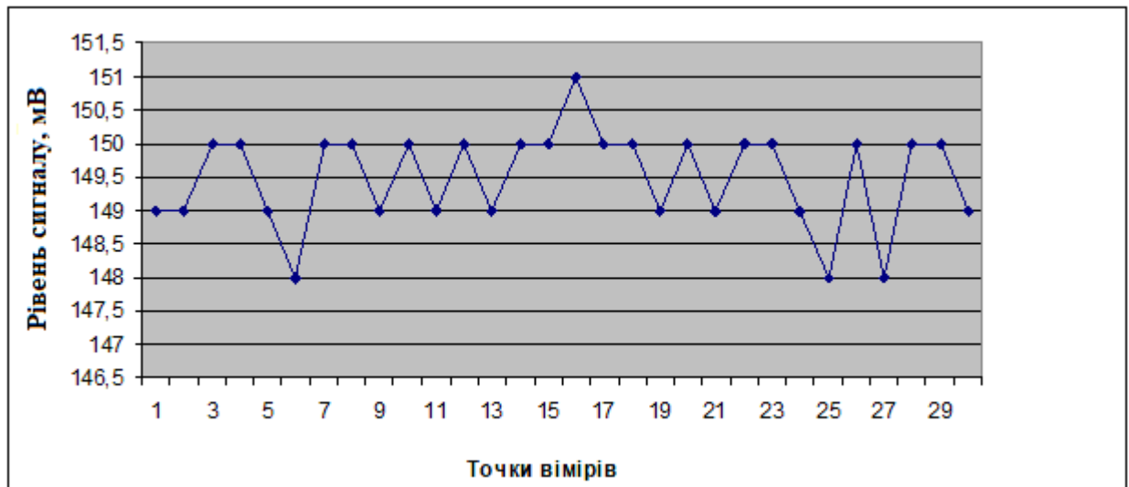
Рис. 5.1 – Результати спостережень за зміною напруги у каналі червоного діода
