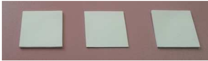
Рисунок 5.7 – Зразки відбивача світла на основі полісилоксануСКТН-мед з пігментом \text{TiO}_2
