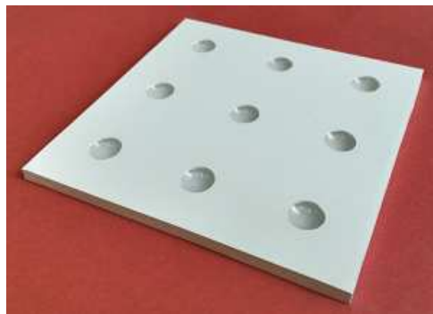
Рисунок 5.15 – Сцинтиляційний детектор на основі сцинтиляційних елементів з полістиролу з дифузним відбивачем
