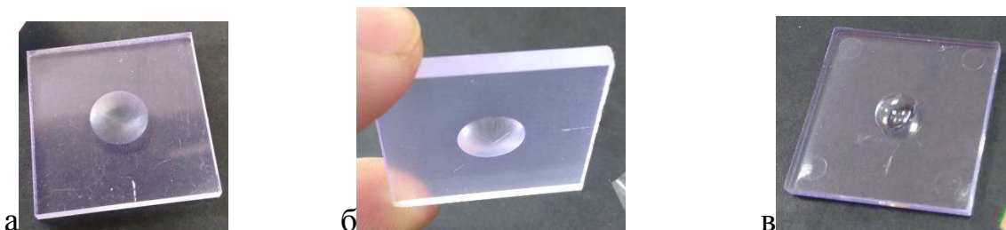
Рисунок 5.13 – Зразки пластмасових сцинтиляторів, отриманих методом блокової полімеризації з полістиролу (а), полівінілтолуола (б) та лиття під тиском (в) без відбивача
