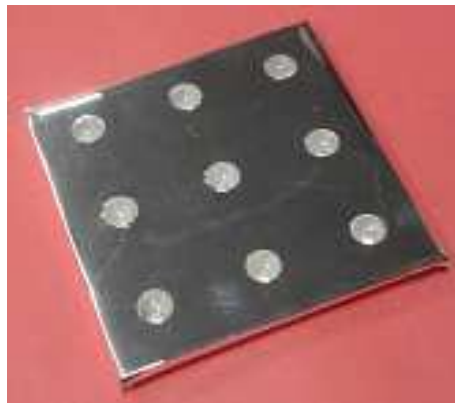
Рисунок 5.17 – Сцинтиляційний детектор на основі сцинтиляційних елементів з полістиролу в дзеркальному відбивачі світла.
