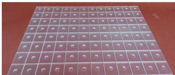
Рисунок 5.19 – Пластина з полістиролу з пазами для заливки відбивача та лунками під фотоприймачі
