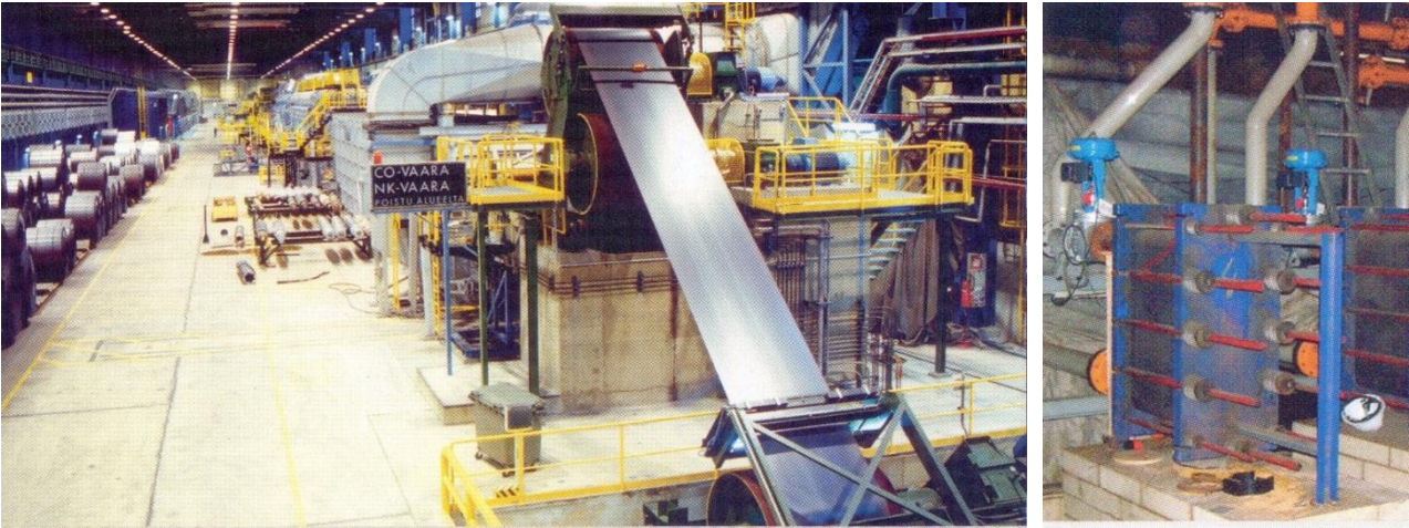
Рисунок 1.1 – Загальний вигляд травильної лінії і секції підігріву розчину
