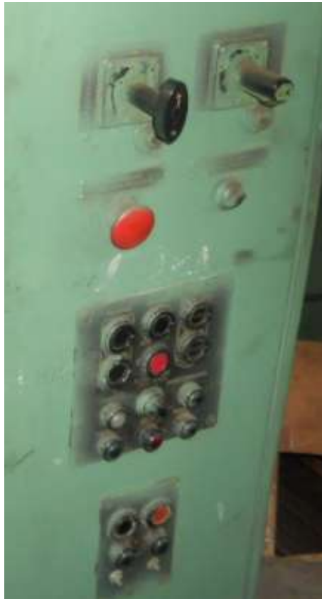
Рисунок 6.33 – Ручна система управління преса гідравлічного ДА2238Б
