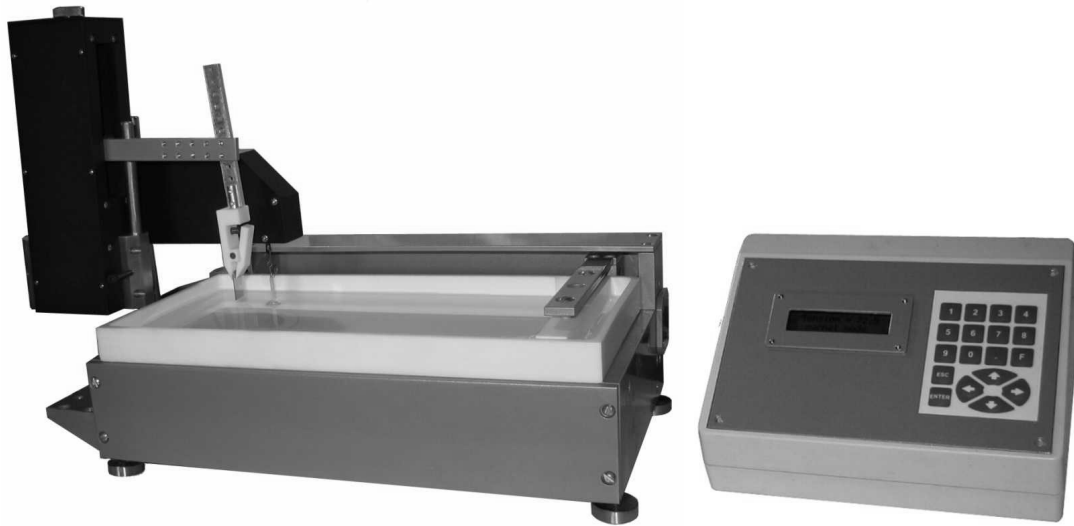
Рисунок 2.18 – Фотографія ванни Ленгмюра- Блоджетт LT-102, Microtestmachines Co. і блоку управління до неї
