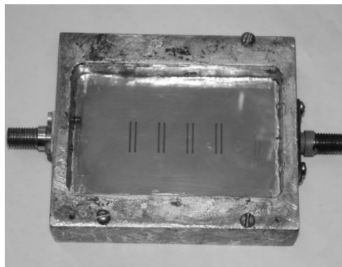
Рис. 4.14. Макет періодичної структури із зв'язаних ЦР у заземлюючій площині МСЛ.
