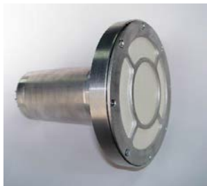
Рисунок 13 – Комбінований детектор для реєстрації альфа- та бета-частинок на основі гетерогенного шару ZnSe:Al
