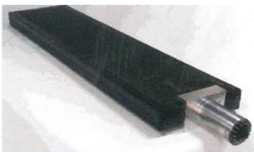
Рисунок 11 – Лічильний комбінований детектор CsI:Tl-ПС для реєстрації фотонів гамма-випромінювання
