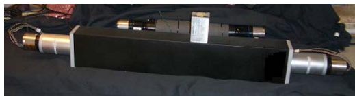
Рисунок 12 – Спектрометричний комбінований детектор NaI:Tl-ПС для реєстрації фотонів гамма-випромінювання
