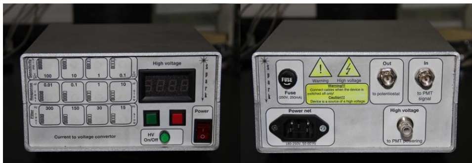
Рис. 17. Зовнішній вигляд приладу «Spark» (зліва – фронтальна панель, справа – задня панель)
