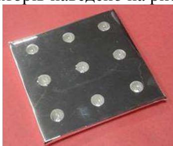
Рисунок 22 –Прототипи багатоелементні сцинтиляційні детектори у дзеркальному (б) та дифузному (в) відбивачах
