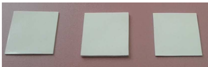
Рисунок 16 – Зразки дифузного відбивача на основі полісилоксану з TiO_2
