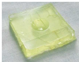
Рисунок 21 – Сцинтиляційний елемент з композиційного сцинтилятора на основі гранул YAGG:Ce з світлопровідним шаром з полісилоксану до нанесення відбивачу (а) та в радіаційностійкому дифузному відбивачі (б)
