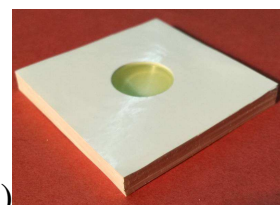
Рисунок 21 – Сцинтиляційний елемент з композиційного сцинтилятора на основі гранул YAGG:Ce з світлопровідним шаром з полісилоксану до нанесення відбивачу (а) та в радіаційностійкому дифузному відбивачі (б)
