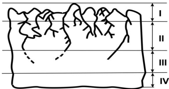
Рисунок 1 – Шари пластини ФК, що зазнають фізико-технологічних впливів і механічних порушень: I – рельєфний шар; II – порушений шар; III – деформований шар; IV – непорушена структура підкладки ФК
