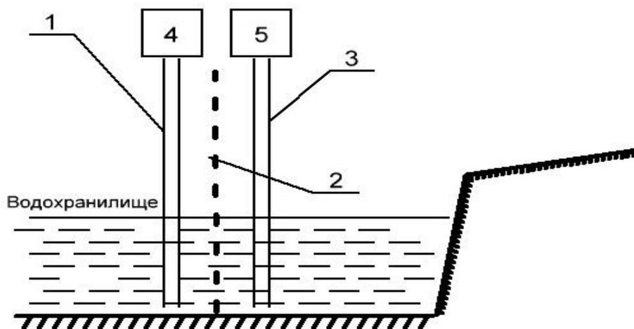
Рис.1. Установка уровнемеров
