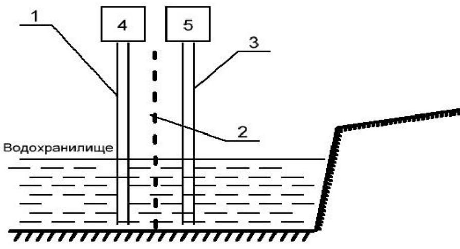
Рис.1. Установка уровнемеров
