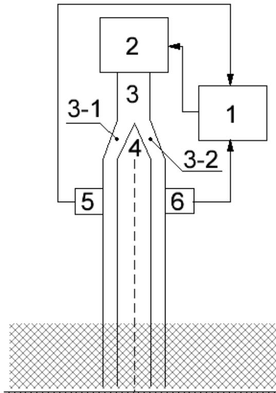
Рис. 2. Уровнемер для контроля разности уровней жидкости
