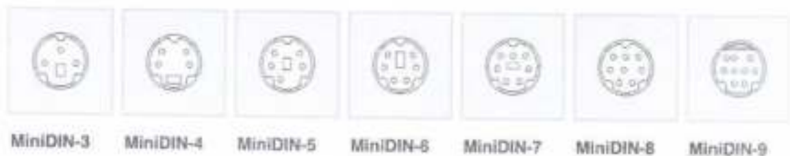
Рисунок 5.2. – Різні версії роз'ємів MiniDIN в залежності від кількості контактів.
