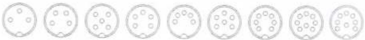
Рисунок 5.1. – Різні версії роз'ємів DIN в залежності від кількості контактів.
