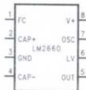
SOIC (D) and VSSOP (DGK) 8 Pins Top View
