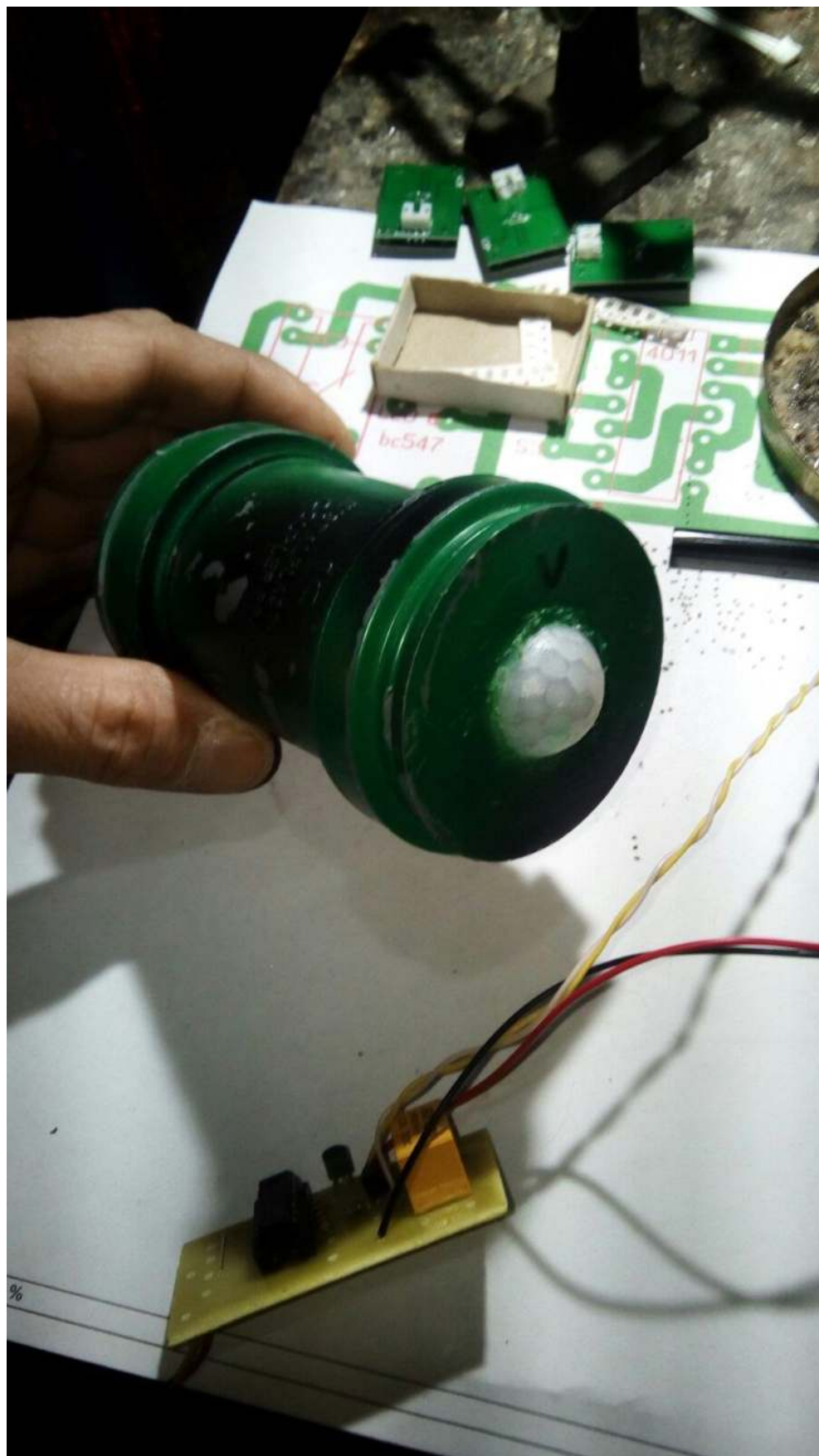
Рисунок К.4 - Зовнішній вигляд модуля з піроелектричним датчиком HC-SR501 та мікрохвильовим датчиком руху XYS-WB-DC у герметичному корпусі
