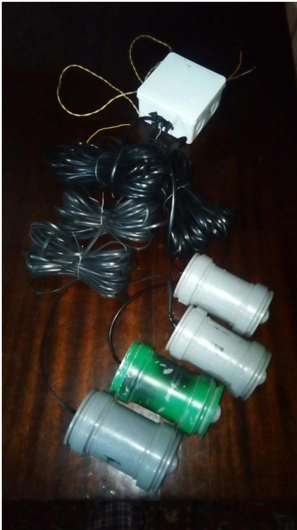
Рисунок К.5 – Зовнішній вигляд чотирьох виносних модулів з піроелектричними датчиками HC-SR501 та мікрохвильовими датчиками руху ХУС-WB-DC у герметичних корпусах, що підключені до блока керування (у білому корпусі)
