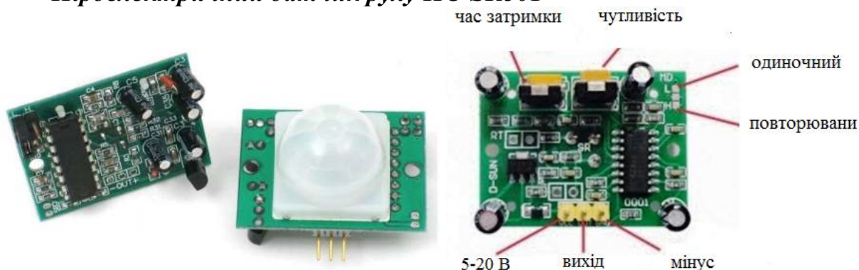
Рисунок Ж.1 – Зовнішній вигляд (а) та розташування елементів (б) піроелектричного датчика HC-SR501
