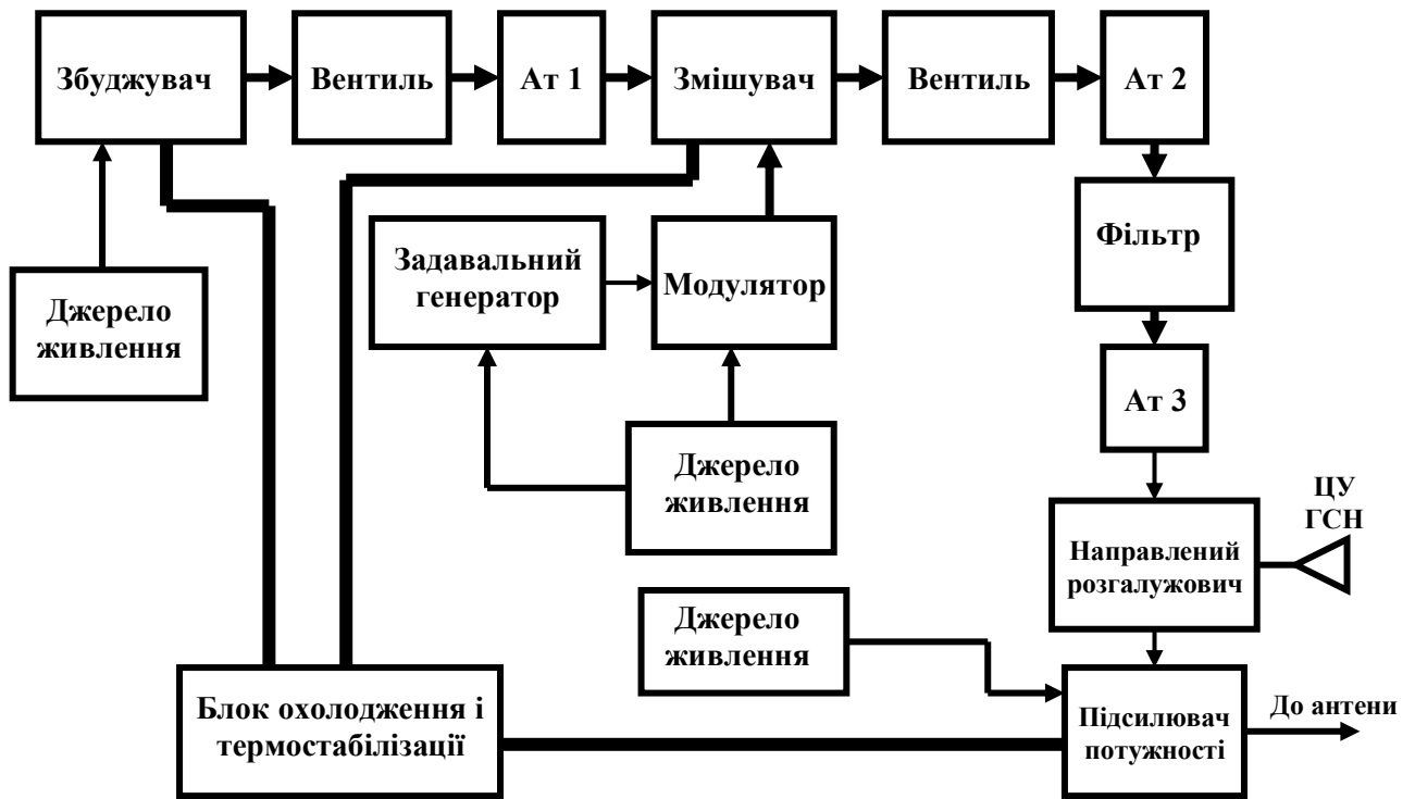
Рисунок 3.1 – Структурна схема передавача підсвічування цілі каналу самонаведення
