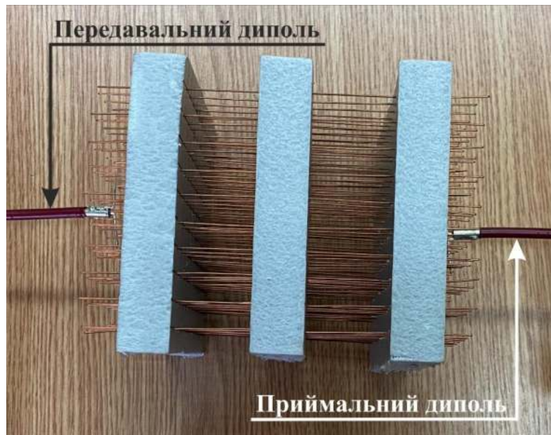
Рис. 2.4. Експериментальний макет для дослідження передавання ЕМ сигналів між двома дипольними антенами (приймальною та передавальною) через СПП у діапазоні суб-ГГц частот та для дослідження роздільної здатності інтерфейсу СПП. Метаструктура складається із провідників довжиною L = 150 мм, радіусом R = 1 мм та періодом їх розташування a = 10 мм.
