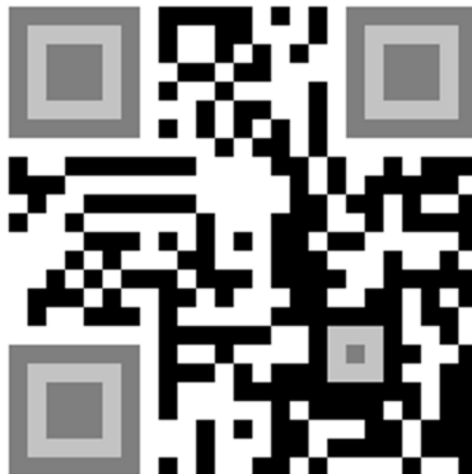
Рисунок 1.7 – Типовий QR-код, світло-сірим кольором позначені синхронізаційні маркери
