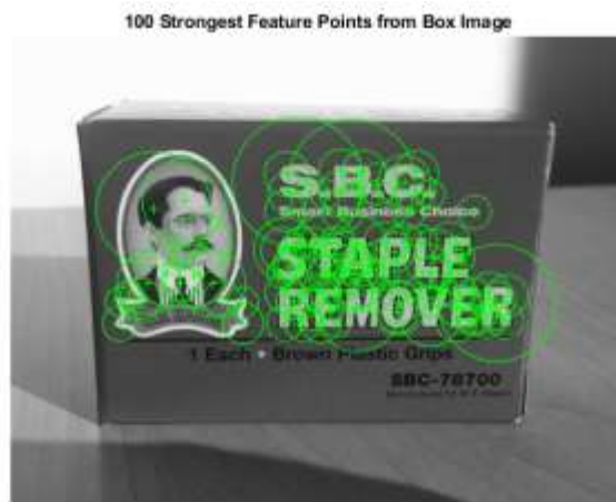
Рисунок 1.16 – Зображення коробки, що взято в якості маркера, візуалізовано 100 найкращих точок з їх SIFT-дескрипторами [30]
