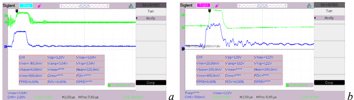
Рис.3. Осцилограми сигналів КЛ, збудженої імпульсним пучком електронів у полістиролі (а) та системі картон+ПП (б).
