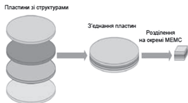
Рис. 1. WLP метод пакування МЕМС датчиків
