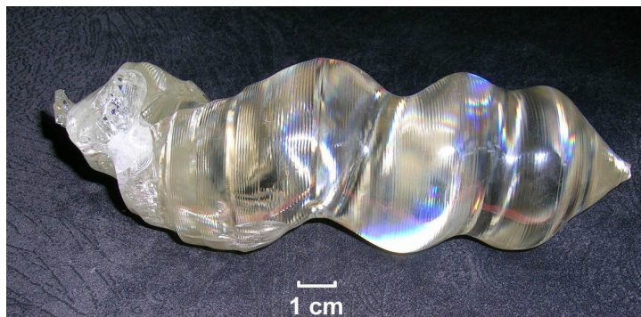
Рисунок 3.13- Кристал \text{PbWO}_4 вирощений при аксіальному температурному градієнті \frac{\partial T}{\partial z} \sim 15-25 \text{ }^\circ\text{C}/\text{см} .
