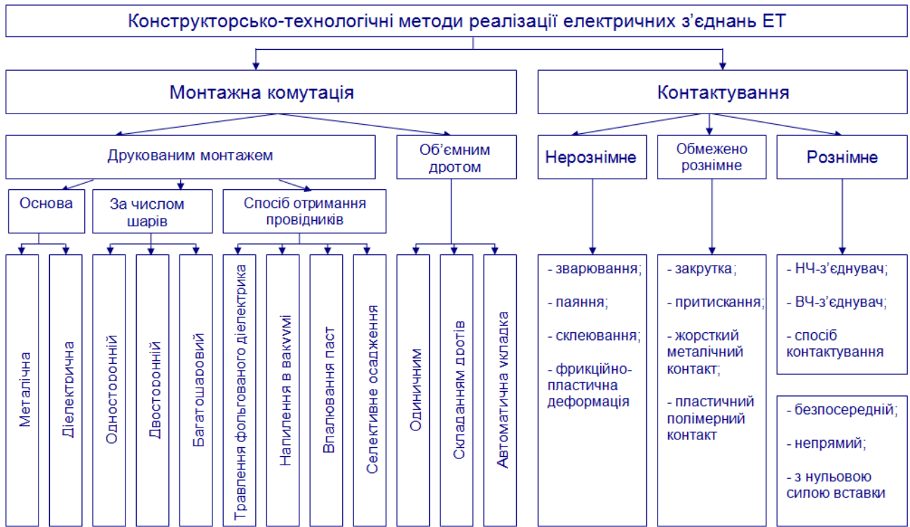
Рисунок 1.1 – Класифікація конструкторсько-технологічних методів реалізації електричних з'єднань ЕТ
