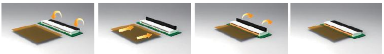
а) принцип роботи заціпки з'єднувача FPC
