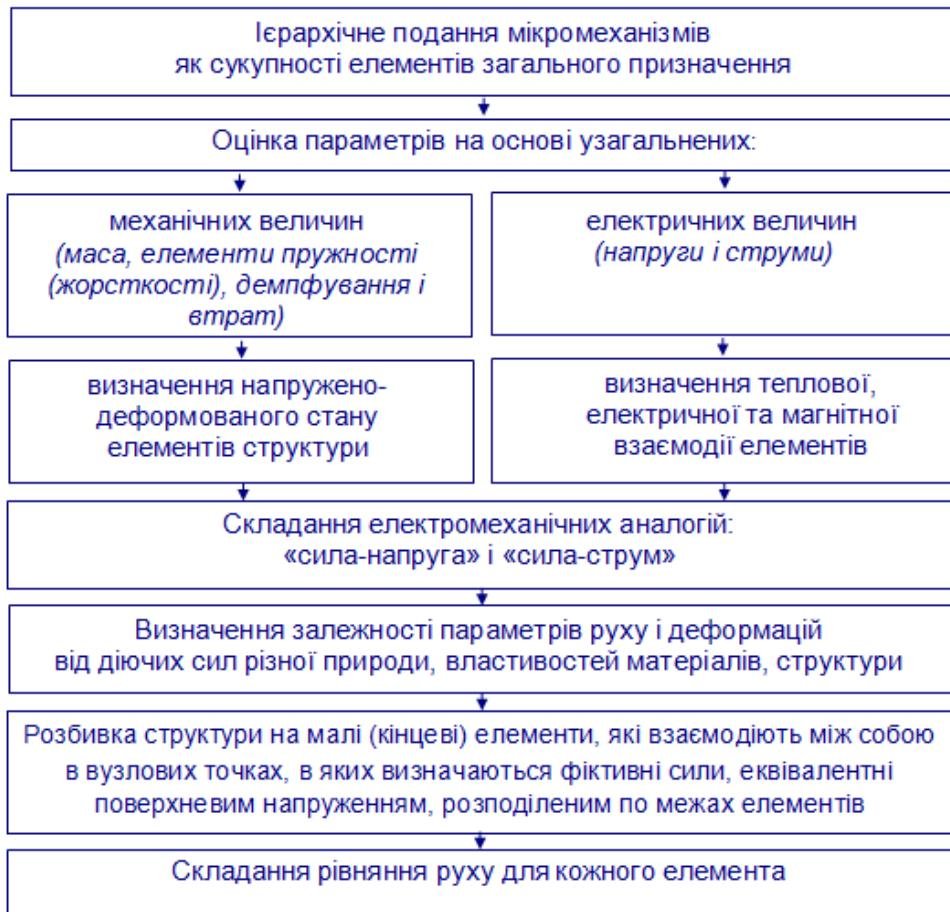
Рисунок 2.1 – Проектування міжз’єднань на основі електромеханічних аналогій
