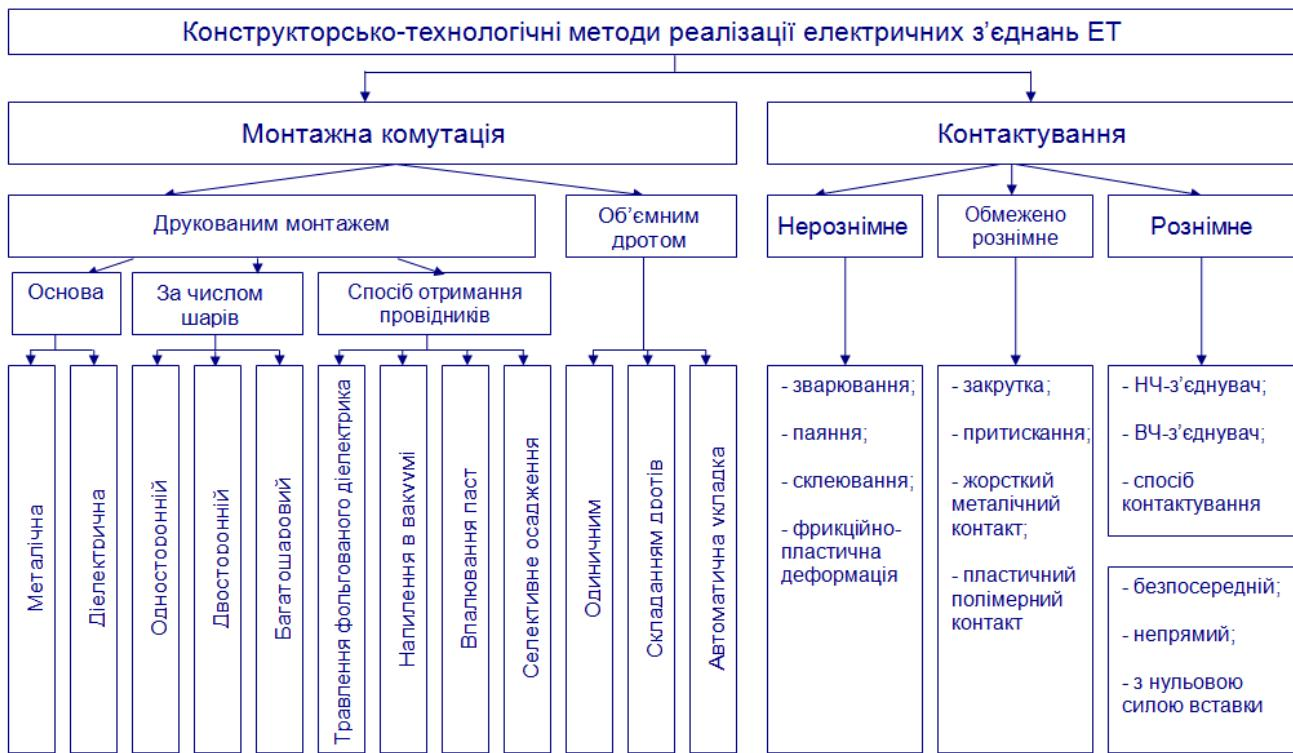
Рисунок 1.1 – Класифікація конструкторсько-технологічних методів реалізації електричних з’єднань ЕТ
