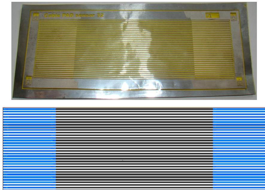
Рисунок 3.3 – Топологія шлейфу-контактора з'єднувача
