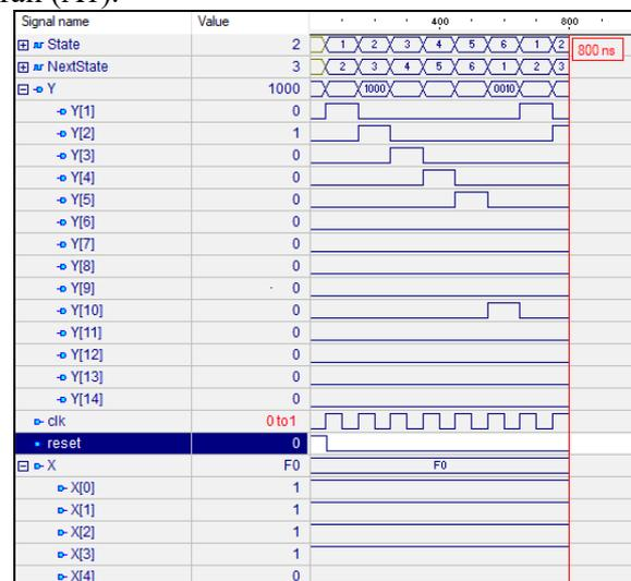
Рис. 6. Waveform роботи КА АГРС
