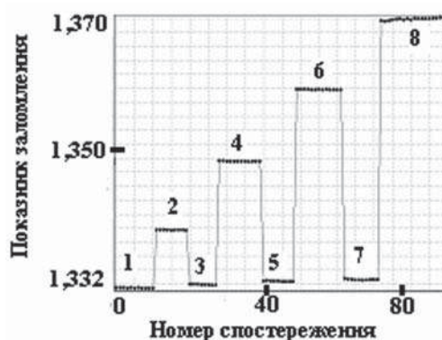
Рис. 10. Сенсограма за ДМА по розчинам сахарози: 1, 3, 5, 7 — значення для деіонізованої води; 2, 4, 6, 8 — значення для мір 1–13, 2–13, 3–13, 4–13, відповідно
