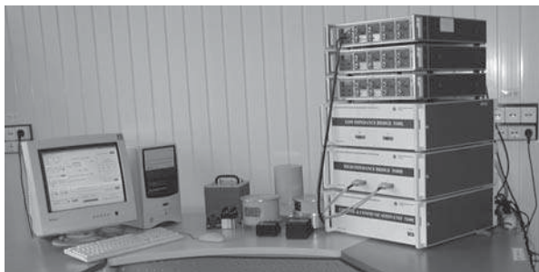
Рис. 1. Державний первинний еталон України одиниць електричної ємності й фактора втрат Fig. 1. National Primary Standard of Ukraine of the unit of capacitance and loss factor
