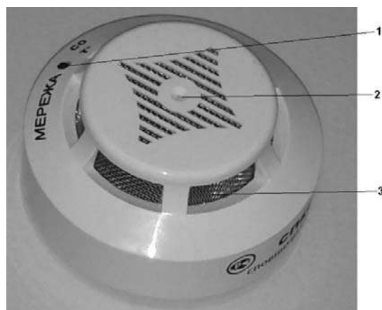
Рис.8. Зовнішній вид СПКГТ-01: 1 — світлодіод; 2 — кришка з прорізами; 3 — металева сітка Fig. 8. Appearance SPKHT-01: 1 — LED; 2 — cover with slots; 3 — metal mesh
