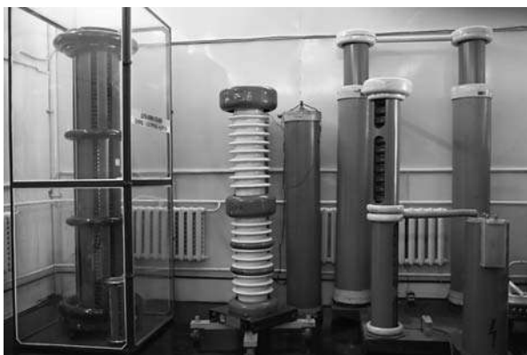
Рис. 1. Державний еталон одиниці електричної напруги постійного струму в діапазоні від 1 до 180 кВ Fig. 1. State primary standard of unit of DC high electrical voltage in range from 1 to 180 kV
